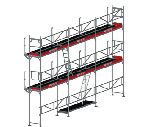
Fig. 2.28: 0.3 konsol på insidan av ställningen
